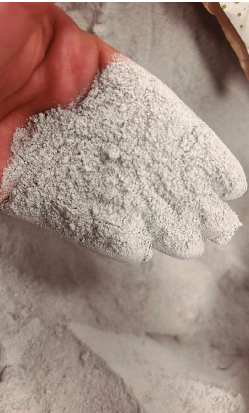
Mortero Beyem Neocal Term en base cal aligerado con corcho natural Foto: Rodacal Beyem
